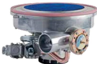
Непрерывная модуляция позволяет работать горелке при максимально низкой мощности, гарантируя при этом оптимальную эффективность. Разработанная по новейшим технологиям, горелка оснащена эксклюзивной электронной системой READ®, обеспечивающей постоянно оптимальное соотношение воздуха/газа в смеси.
