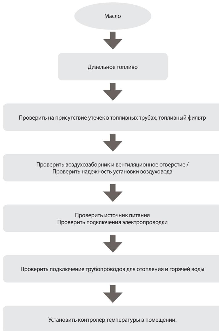
1. Проверить соответствие подачи топлива, указанного в спецификации на лицевой панели.
